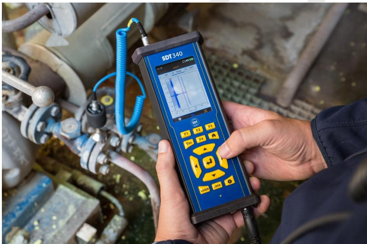
Detecta, modela e analisa a integridade dos ativos visualizando o sinal do tempo de ultrassom e vibração e o espectro diretamente no visor colorido do SDT340.
