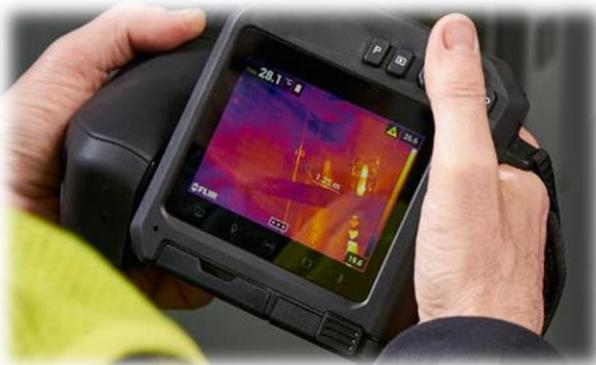
Um simples toque no display lhe dá acesso a configuração, ferramentas de medições, modos de imagens e muitos mais. Interface rápida e dinâmica, traz maior agilidade e precisão no acesso aos menus. O excepcional ângulo de visão de 160° permite melhor visualização do display em diversas condições severas de trabalho.
